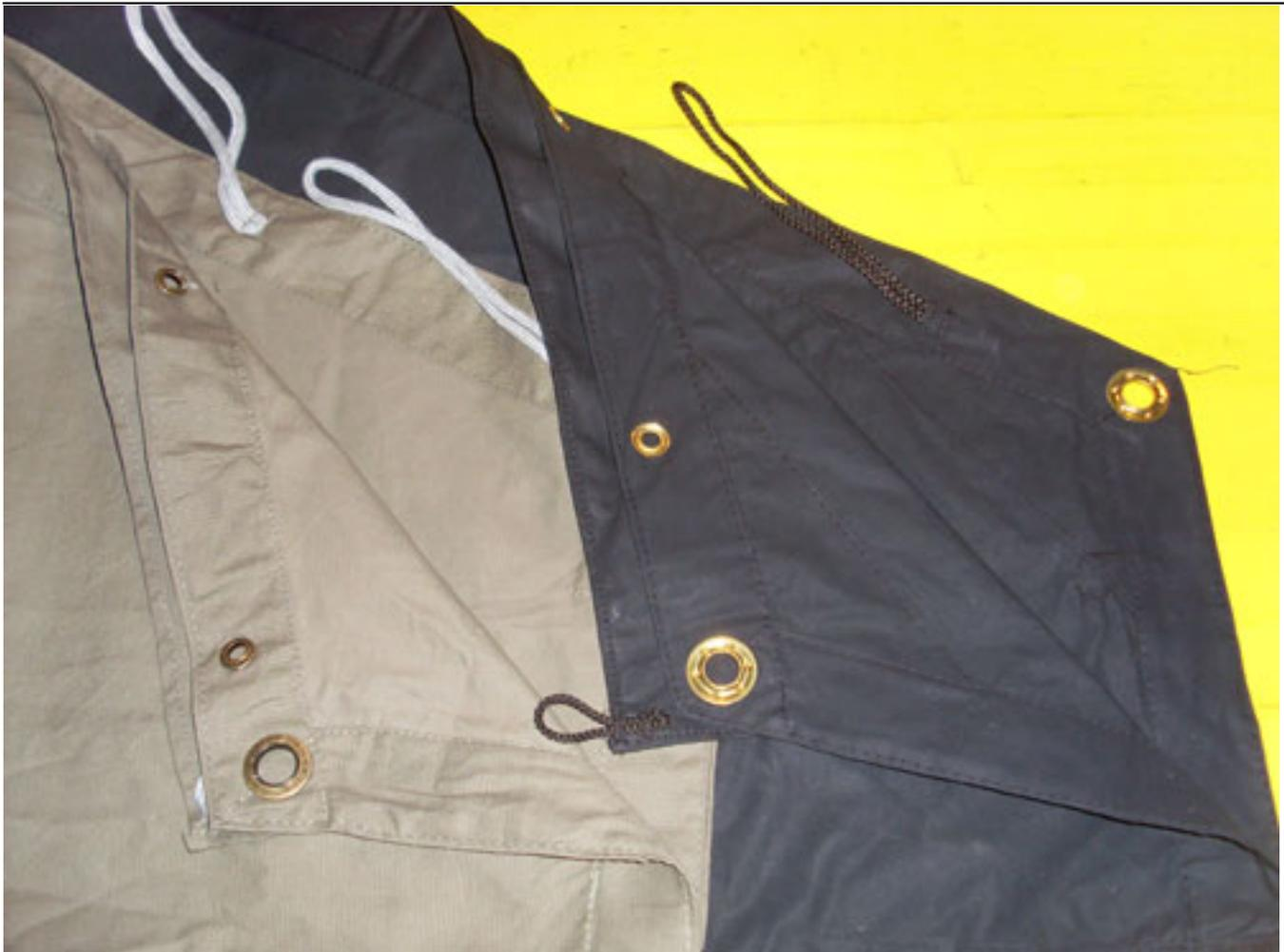
Ein weiterer Grund, warum die Plane leichter ist, liegt daran, dass ausser den Säumen kaum Verstärkungen eingenäht sind. Beim Vergleichsblatt von Tortuga sind die beanspruchten Ecken mit zusätzlichen Stofflagen verstärkt und ausgesteift. Die Kohte aus Fernost verzichtet völlig auf diese Details.
