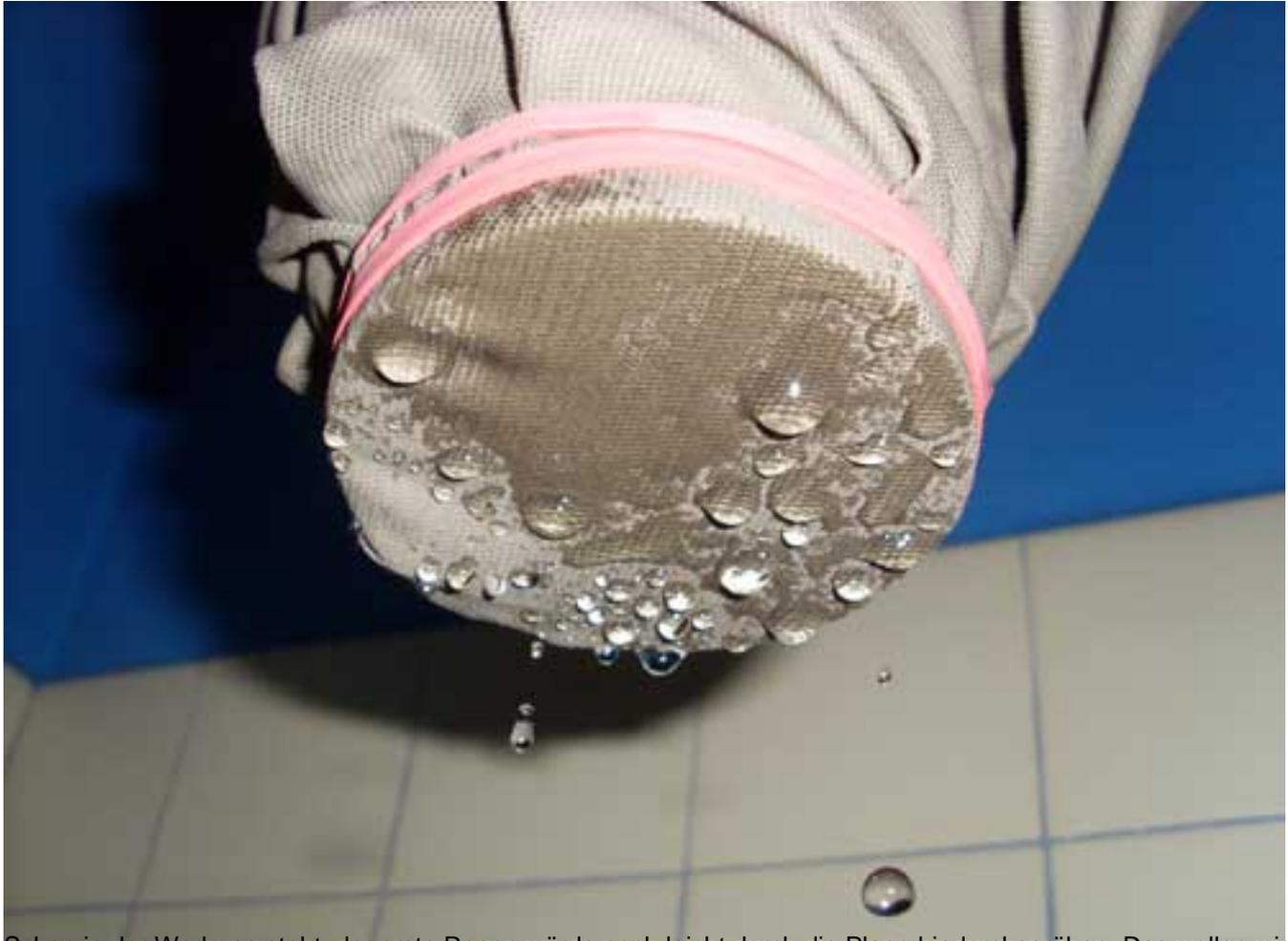
Schon in der Werbung steht, der erste Regen würde noch leicht durch die Plane hindurchsprühen. Das wollen wir dann doch genauer wissen. Immerhin ist auch angegeben, dass der Stoff imprägniert wäre. Bei Zeltstoffen wird die Dichtigkeit des Gewebes als Wassersäule angegeben.
