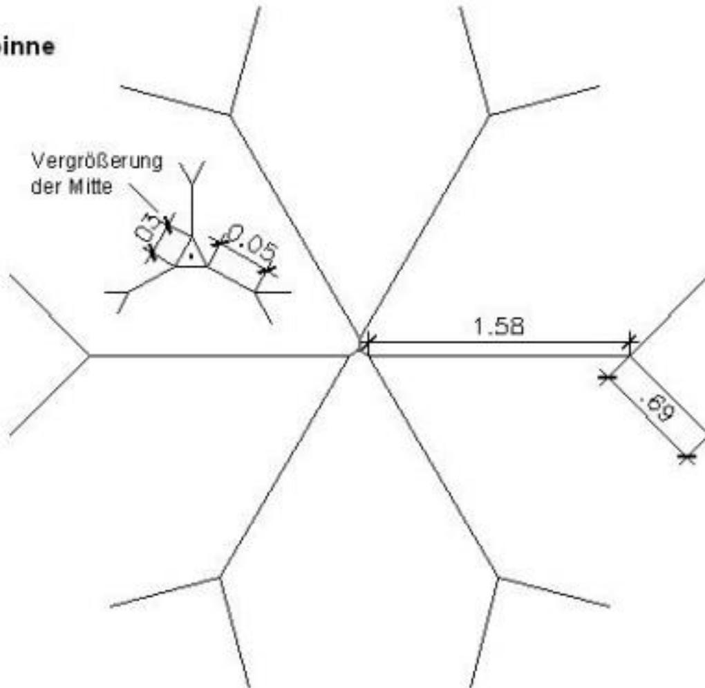
Bei der 9m Jurte (6 Dächer und 6 Theaterbahnen) dann hat man das Problem, das man wenn man aus der Mitte die Spannseile ziehen möchte, die Zugkraft nicht in Richtung der Nähte auftritt. Was fatale Folgen für die Nähte der Bahnen hat. Um das ganze zu verhindern kann man die Kräfte der Kette mit Y-Stücken umlenken. Siehe Zeichnung. So heben sich die Kräfte gegenseitig auf. Und man kann die Jurte gefahrlos mit der Kette aufbauen.
