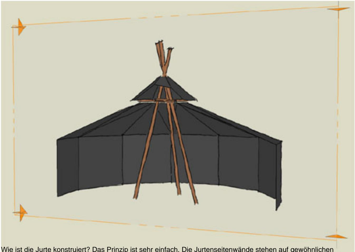
Wie ist die Jurte konstruiert? Das Prinzip ist sehr einfach. Die Jurtenseitenwände stehen auf gewöhnlichen Zeltstangen und sind nach aussen hin mit Zeltschnur und Hering abgespannt. Nun muss einfach nur noch die Mitte Daches nach oben. Wie und womit ist eigentlich egal!
